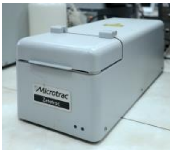
Рисунок 2.3 – Оборудование для определения -потенциала водной эмульсии ПМС
