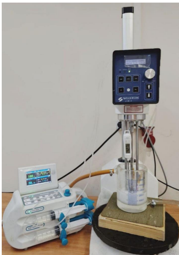
Рисунок 2.1 – Установка для получения водной эмульсии полиметилсилоксанового масла: а – высокоскоростной лабораторный смеситель Silverson L5m-A, б – магнитная мешалка с подогревом ARE
