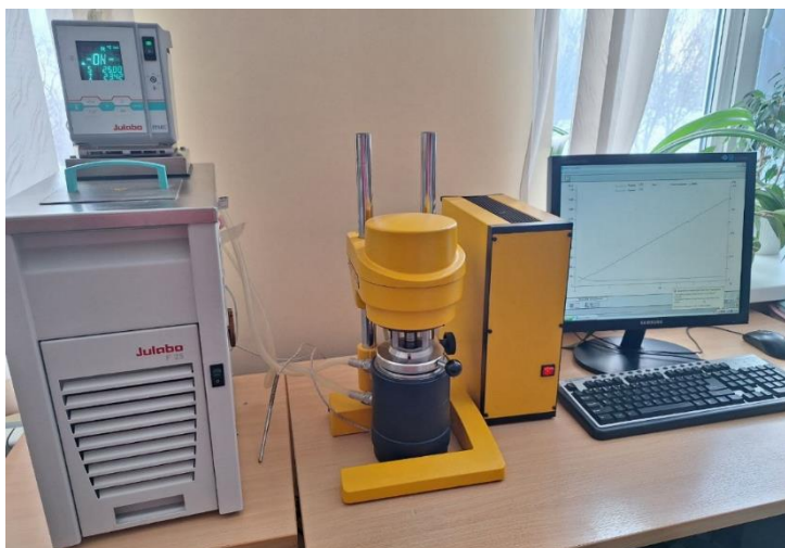
Рисунок 2.2 – Оборудование для определения эффективной вязкости при разнице температур эмульсии
