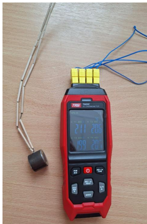
Рисунок 2.6 – Прибор для определения интенсивности теплообмена эмульсии ПМС
