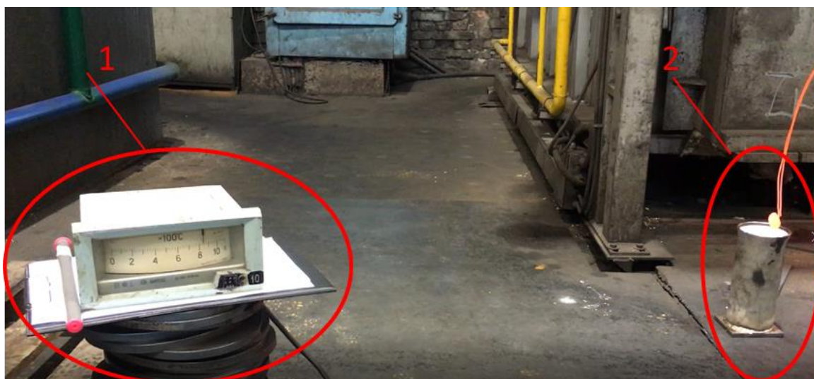
Рисунок 4.2 – Процесс определения скорости охлаждения в опытно-промышленных условиях:
