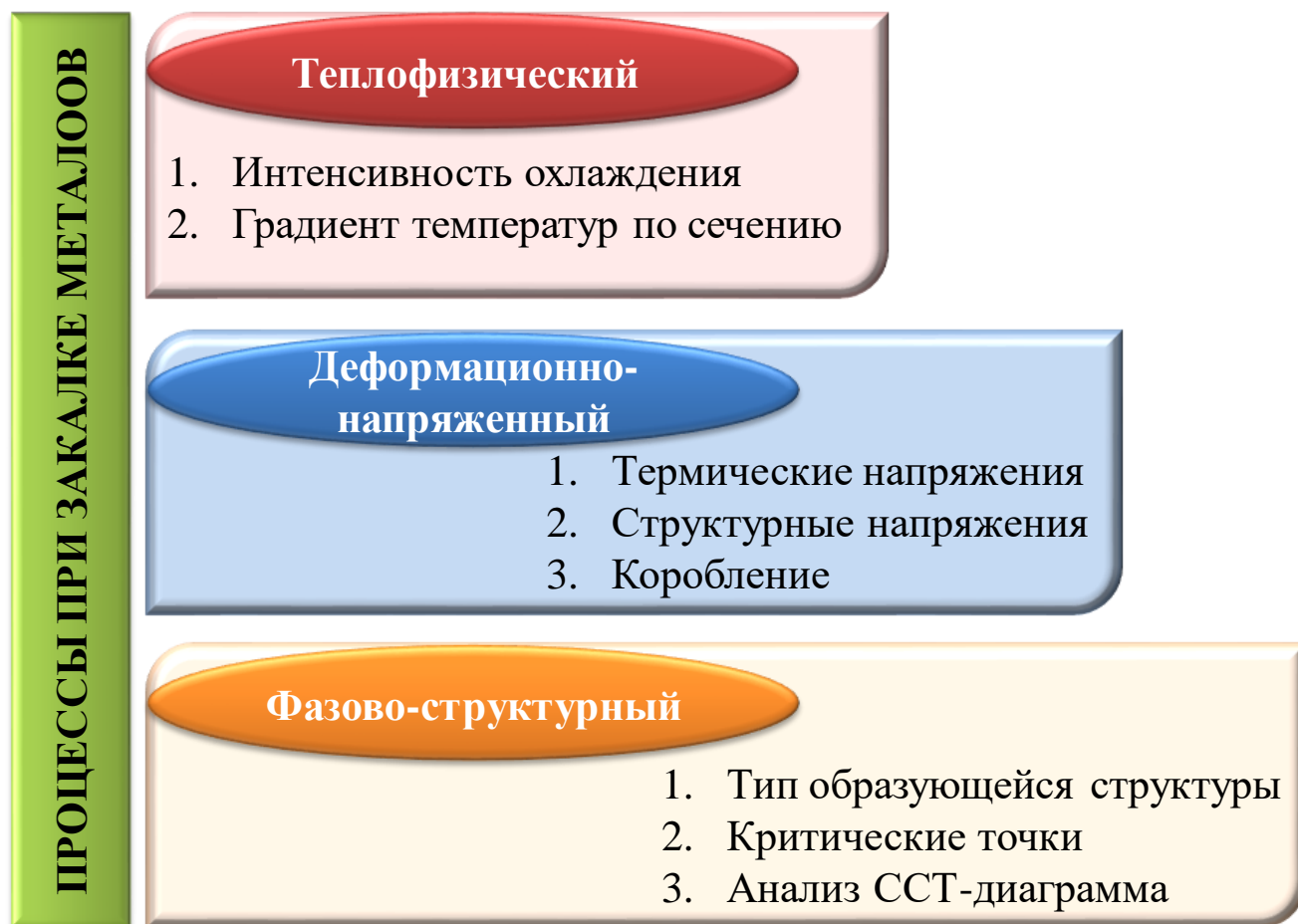
Рисунок 1.3 – Взаимозависимость процессов при закалке металла [35]
