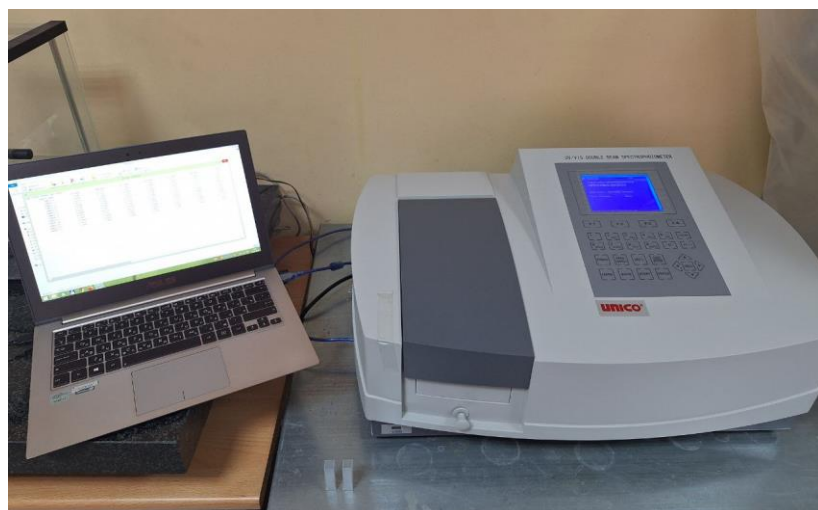
Рисунок 2.5 – Оборудование для определения седиментационной устойчивости эмульсии ПМС
