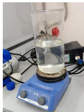
Рисунок 2.1 – Установка для получения водной эмульсии полиметилсилоксанового масла: а – высокоскоростной лабораторный смеситель Silverson L5m-A, б – магнитная мешалка с подогревом ARE
