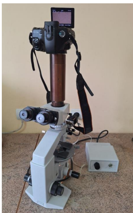
Рисунок 2.4 – Поляризационный микроскоп, для определения структуры эмульсии ПМС
