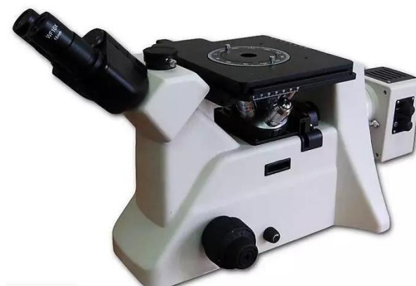
Рисунок 2.8 – Металлографический микроскоп, для определения структуры стали, после закалки в эмульсии ПМС
